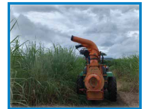
Figura 108. Aplicación de hongos entomopatógenos en campos de caña de azúcar mediante el uso del cañón de aspersión.
