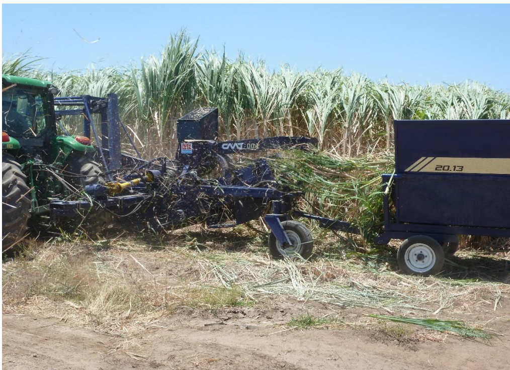
Foto 6. Prototipo de cosechadora mecánica en operación de corta.
