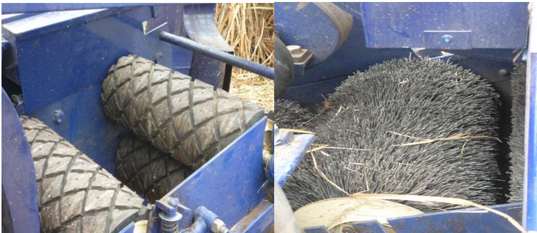
Foto 7. Secciones de conducción y limpieza de los tallos cortados.
