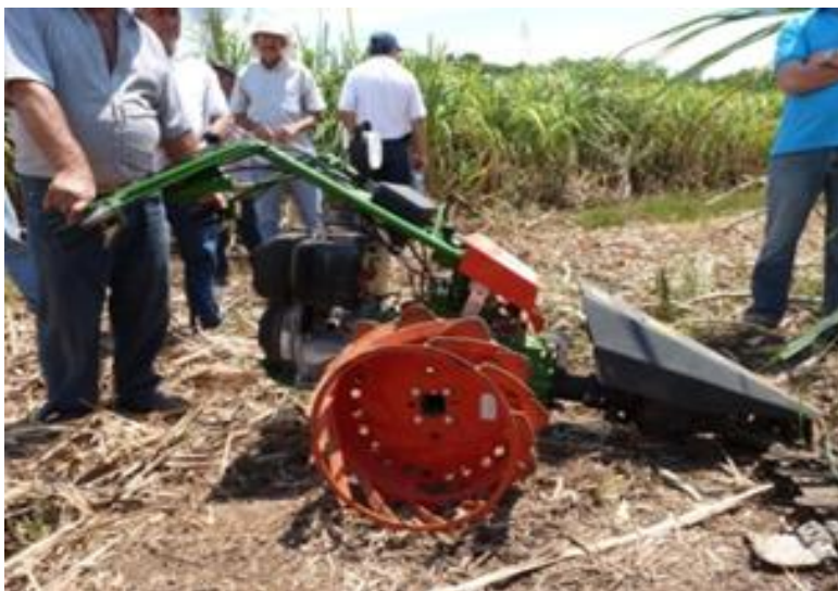
Foto N° 1: Equipo de cosecha mostrando ruedas de hierro.
