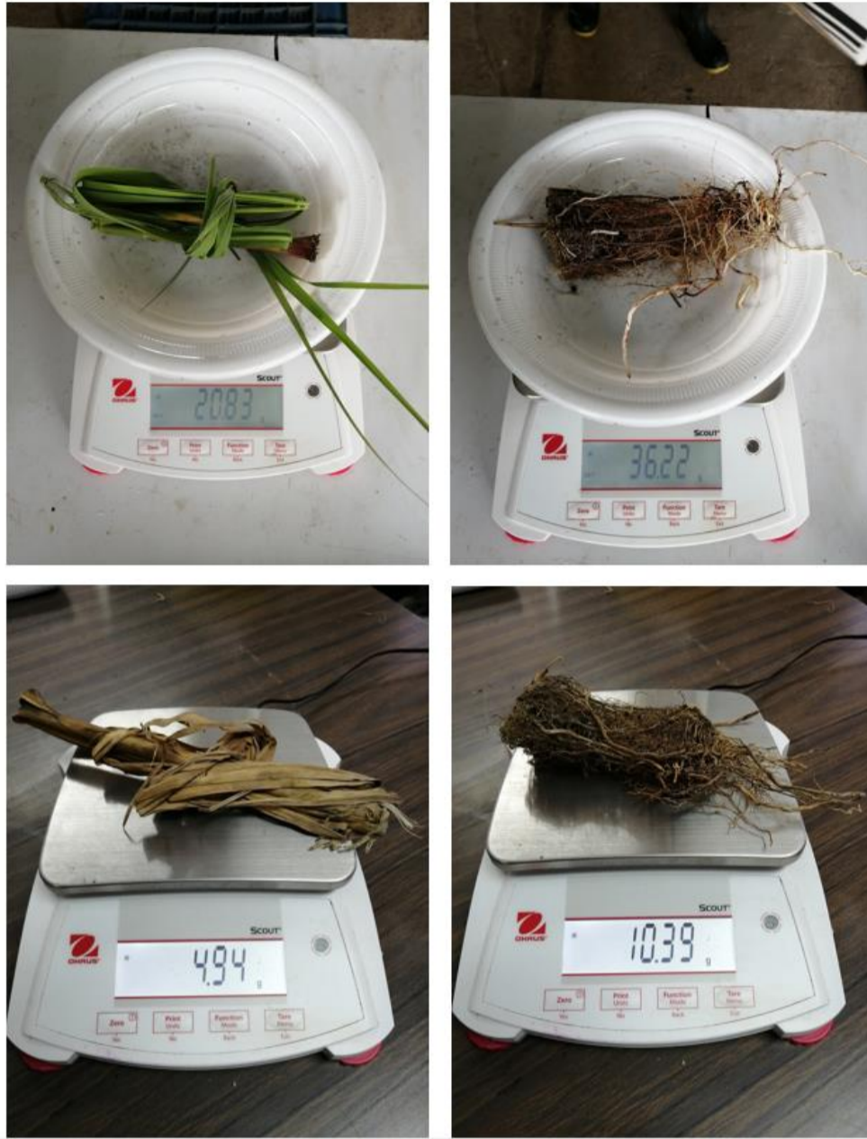
FIGURA 64. Pesaje del material vegetal (peso fresco y seco de tallo + hojas y de raíz).
