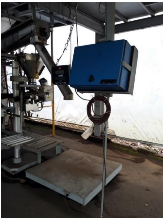
FIGURA 54. Reconstrucción de la romana para el pesaje de producto final.
