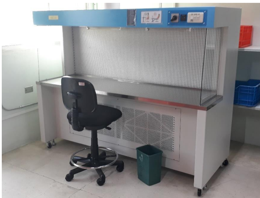
FIGURA 38. Cámara de flujo laminar para preparación de dietas e inoculación de huevos.
