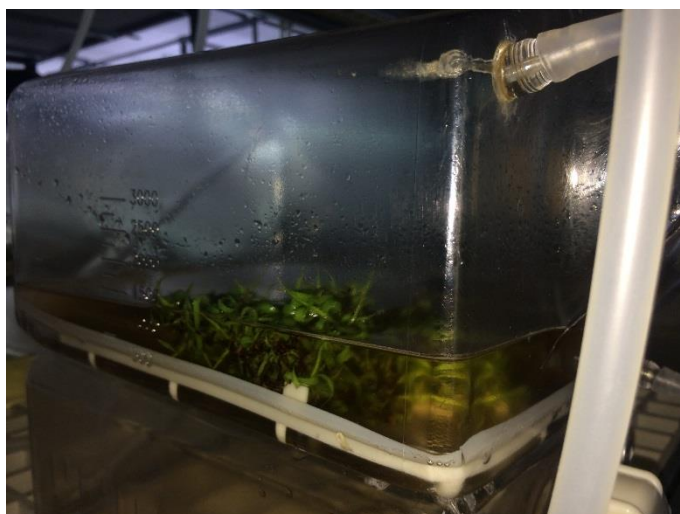
Figura 7 Biorreactor de inmersión temporal con el medio en estado activo con el medio de cultivo bañando las plantas.
