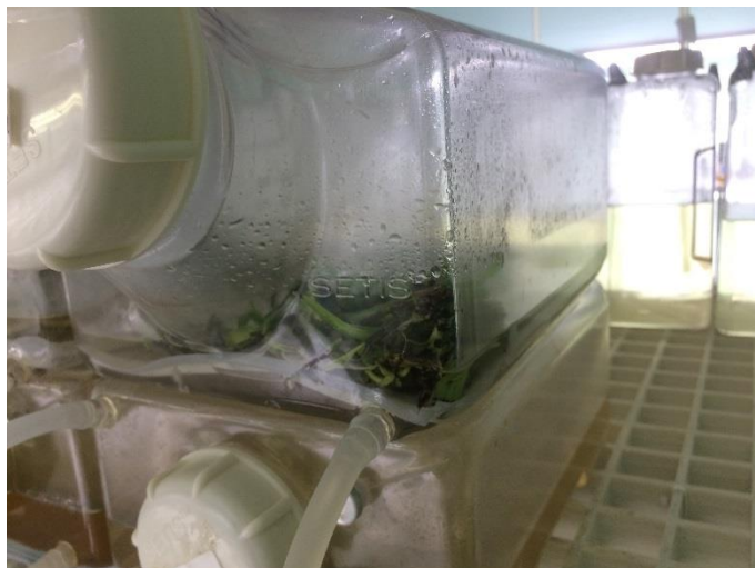
Figura 6 Biorreactor de inmersión temporal con el medio de cultivo en reposo.
