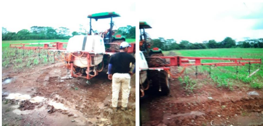
Figura 40. Uso del spray boom en el control de mala hierba.
