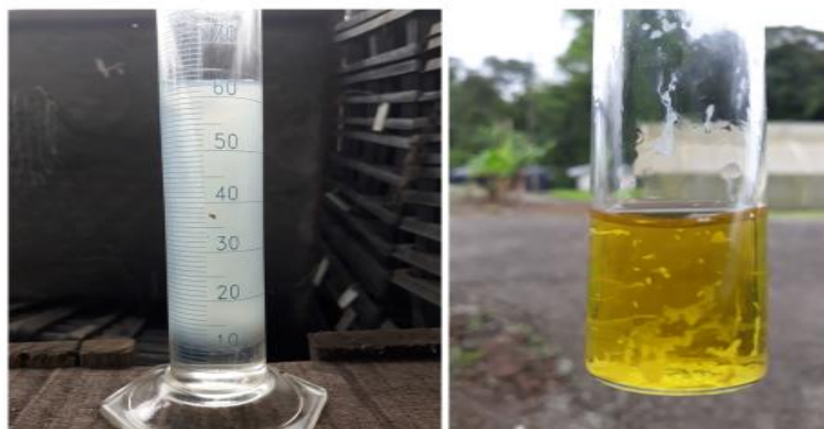
Figura 10. Incompatibilidad en la mezcla de plaguicidas, manifestada con turbidez y formación de micelas.
