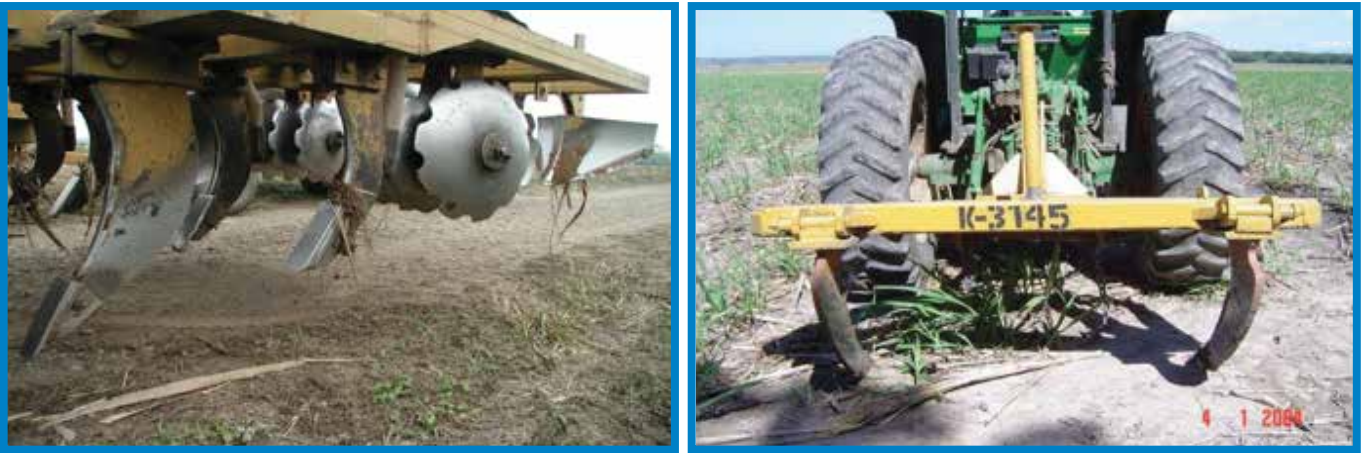
Equipos para subsolar suelos compactados.
