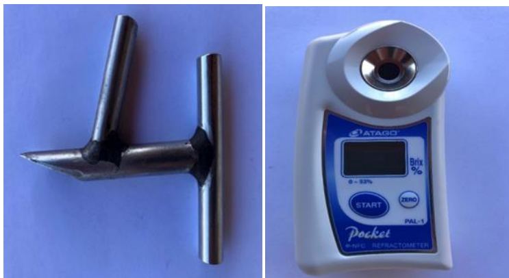
Figura 51. Punzón para extraer el jugo y refractómetro digital para realizar las lecturas de Brix.
