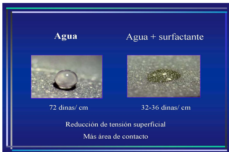
Figura 3 Rompimiento de la Tensión Superficial de una Gota de Agua por un Surfactante.
