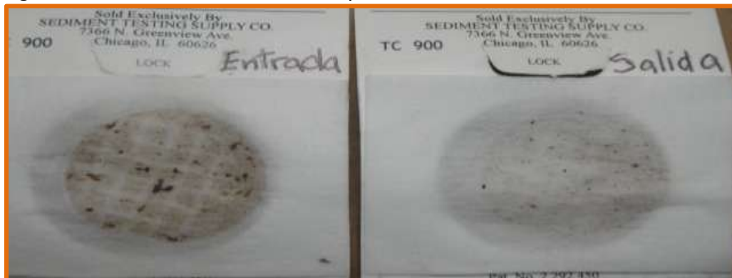
Fig. 10: Filtración de licor de entrada y salida
