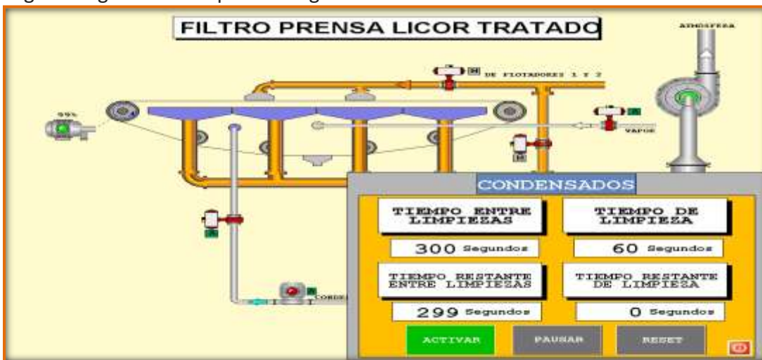
Fig. 6: Diagrama de limpieza de agua de filtro banda
