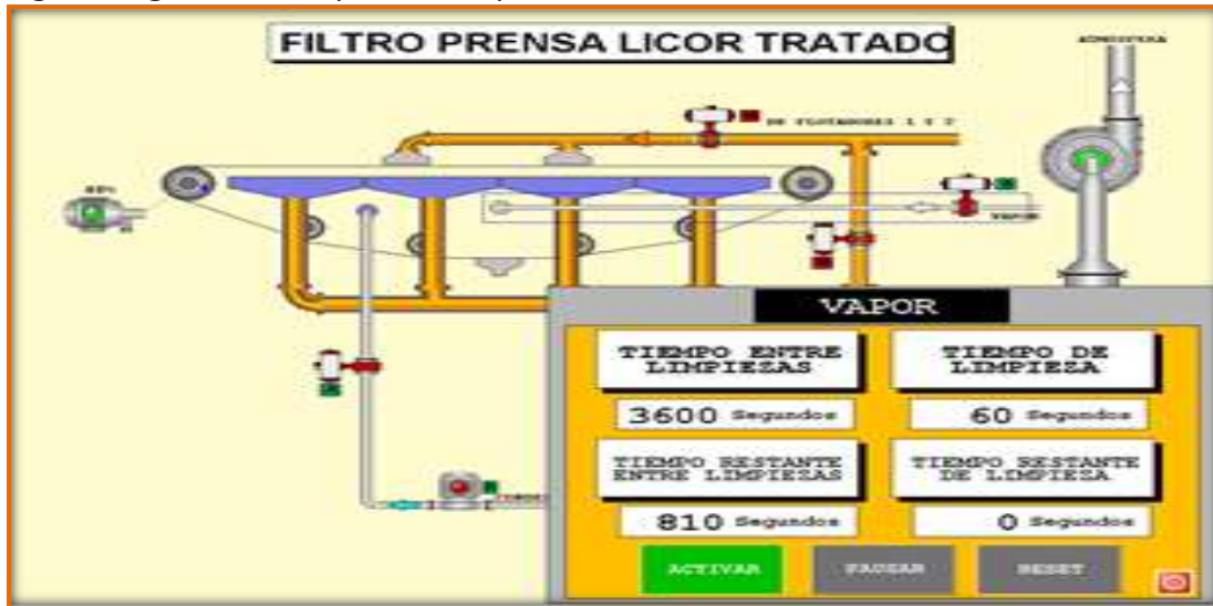
Fig. 8: Diagrama de limpieza de vapor de filtro banda
