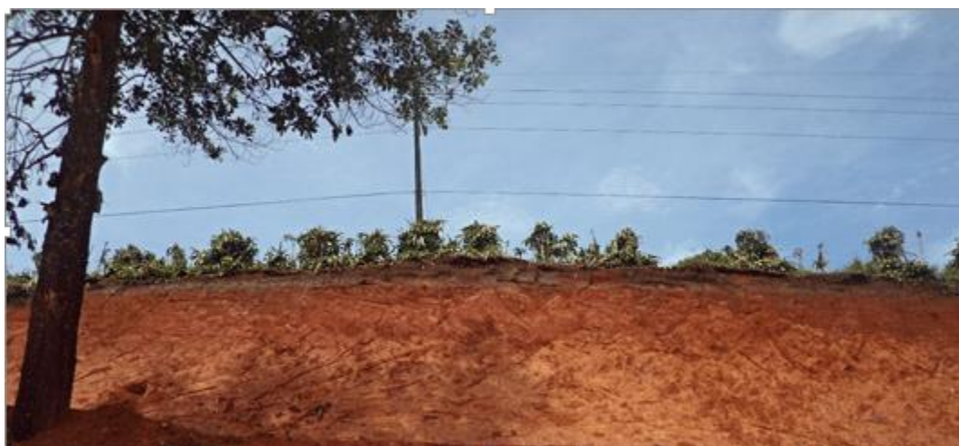
Figura 7. Perfil de suelo orden Ultisol de La Fortuna de San Pedro, Pérez Zeledón, Región Sur.
