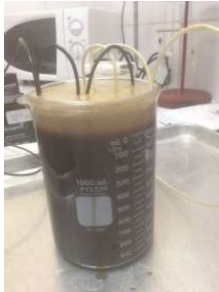
Figura 2. Ensayo en batch electrocoagulación de meladura
