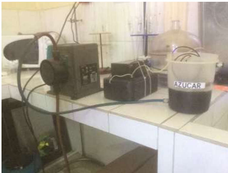
Figura 6. Sistema de flujo continuo de electrocoagulación de meladura
