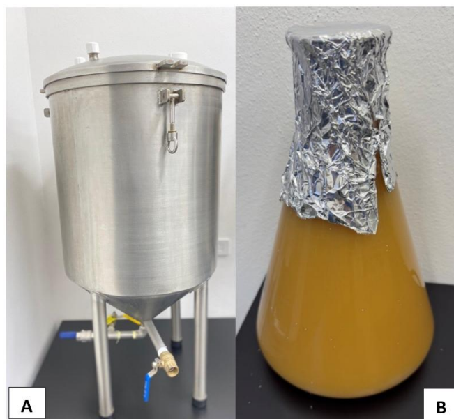
Figura 7. Proyecto de escalamiento productivo de bacterias benéficas: (A) Biorreactores y (B) Producto final.
