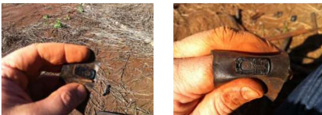
Figura 3 - Bajo goteo flujo de 0,6 l / h (izquierda) y 1.0 L / h (a la derecha)
